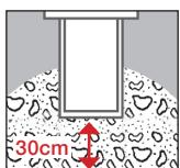
Für alle Leuchten ist es notwendig, für eine ausreichende Drainage in Form einer Kiesschicht von mindestens 25–30cm zu sorgen, die eine ausreichende Entwässerung sicherstellt und stehendes Wasser verhindert.
